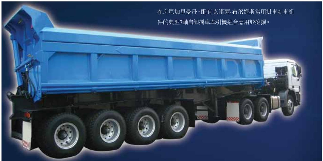
在印尼加里曼丹，配有克諾爾-布萊姆斯常用掛車剎車組件的典型7軸自卸掛車牽引機組合應用於挖掘。
