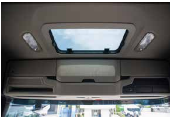
กระจกระบายอากาศ เปิด - ปิดด้วยไฟฟ้า พร้อมม่านกันแสง
